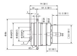
Input Shaft Diameter  $\leqslant \varphi$  14  $\,$  (in mm)
