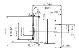
Input Shaft Diameter  $\leqslant \varphi$  19 (in mm)
